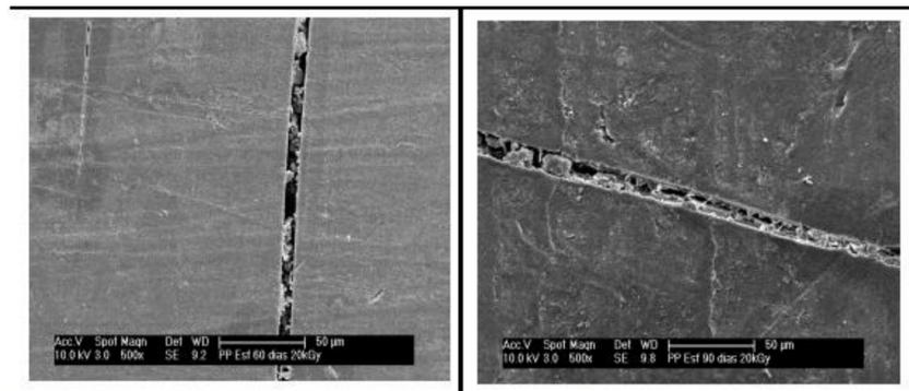
FIGURA 20 - Micrografias escala de 50µm (até 90 dias) de amostras de PP Esfera 20 kGy, expostas ao envelhecimento natural.
