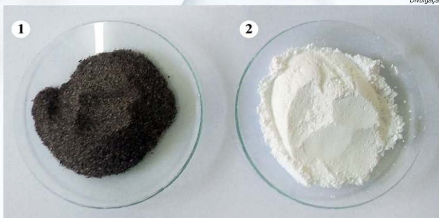
1) Cinzas da biomassa de cana e 2) Nanosílica de alta pureza extraída do processamento das cinzas
