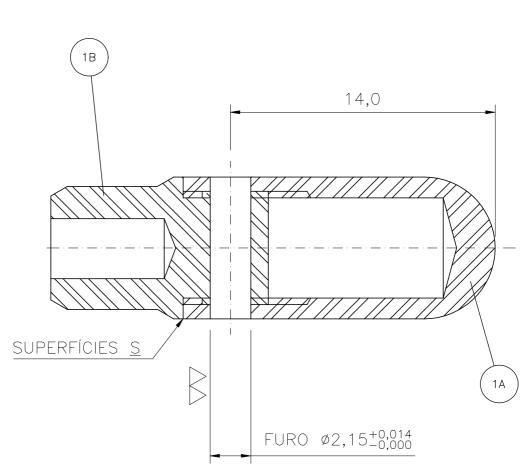
REMOVER REBARBAS DAS PEÇAS 1A E 1B ROSQUEAR A PEÇA 1A NA PEÇA 1B, MANUALMENTE ATÉ FINAL, GARANTINDO ENCOSTO DAS SUPERFÍCIES <u>S</u>. NÃO APLICAR TORQUE. EXECUTAR A FURAÇÃO UTILIZANDO GABARITO P/ GARANTIR CENTRALIZAÇÃO DIAMETRAL E COTA 14.
