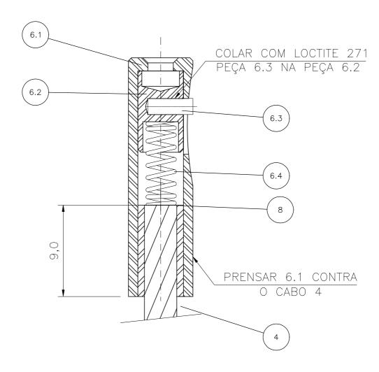
PEÇA 6- FABRICAR \_\_\_\_ CONJUNTOS TOLERÂNCIAS NÃO INDICADAS= js12
